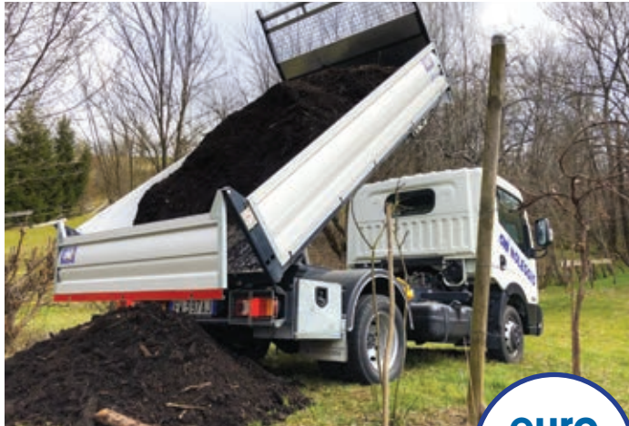
Autocarro 35 q.li cassone ribaltabile 3,10x1,88 mt portata max 13 q.li - 3 posti
